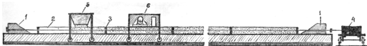
Стенд для изготовления линейно-армированных изделий. 1—упоры, 2—формы-матрицы, 3—перегородки, 4—натяжная тележка с гидравлическим домкратом, 5—катучий бетоноукладчик, 6—катучий виброштамп.
